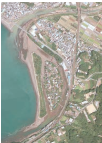
写真3 平成23年9月7日撮影の空中写真(国土地理院ウェブサイトから取得) 浜畑地区海岸部に防潮流堤と防潮流林があります。なお、この写真は「紀伊半島大水害」をもたらした台風12号豪雨直後の撮影です。増水により大字島田・西ノ地境の「打越」が決壊し、河水が海へ「打ち越し」ています。
