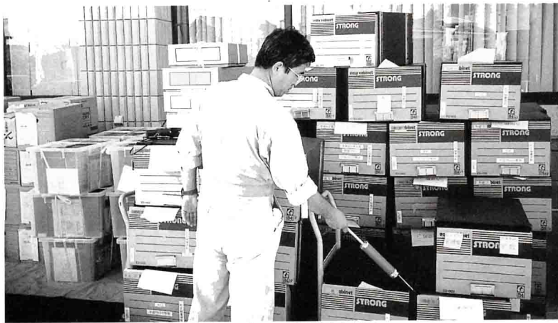
有害なガスの残留濃度測定
