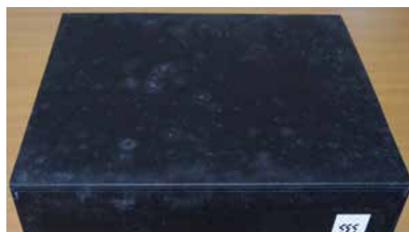
写真4 保存容器に発生していた白カビ。エタノールで拭き取りカビを除去することができたため、容器を交換するには至らなかった。
