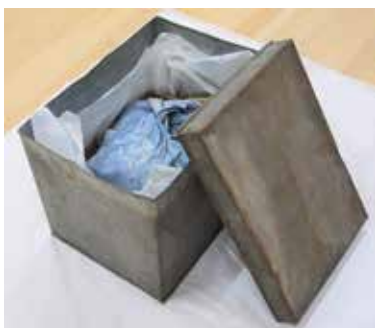
写真3 ブリキ製の箱。蓋部分や箱側面にさびが生じている。文書類と箱とが直に接しないように内部に薄葉紙を敷いている。
